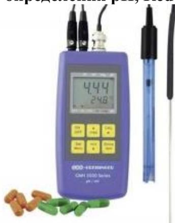
Прибор GMH 3511 для определения pH, Redox (ОВП), температуры.
