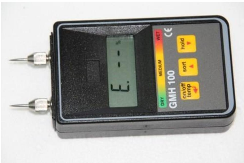
Измерение влажности пиломатериалов, ДСП, фанеры, дров, деревянных брикетов
