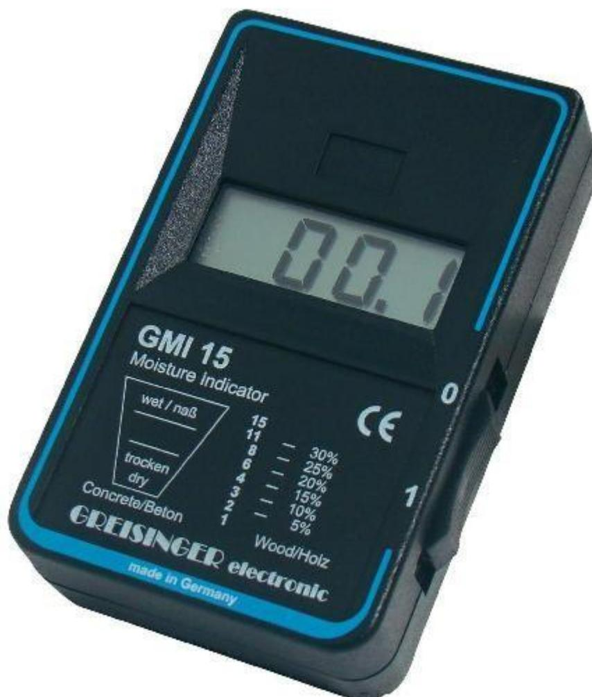
Для быстрого определения влажности при строительстве различных сооружений. С помощью влагомера GMI-15 Вы можете измерить влажность древесины на глубине до 3 см, бетона или стяжки до 4 см. Но особенность GMI-15 то, что он узнает влажность за керамической плиткой или за различными облицовками стен и напольными материалами. Для измерения влажности, просто положите устройство на измеряемую поверхность. Нет необходимости проникновения!
