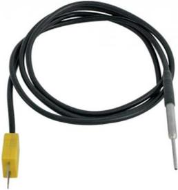
Прочный датчик температуры для измерения температуры различных материалов. Длина датчика температуры 25 мм., толщина 2,2 мм., длина соединительного кабеля ок. 1 м. с мини-штекером. Тип датчика NiCr-Ni.
